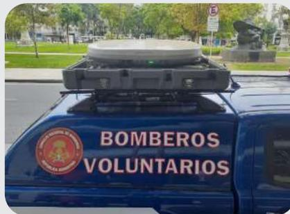
Se trata de una antena satelital para Internet, del estilo que se utilizan tanto en los móviles de televisión como en los vehículos de las fuerzas de seguridad, la cual permite una comunicación efectiva y constante desde el móvil operativo donde esté ubicada con los puestos de la zona como a su vez con las bases en, por ejemplo, incendios forestales o cualquier otro tipo de emergencia dentro del territorio nacional.
